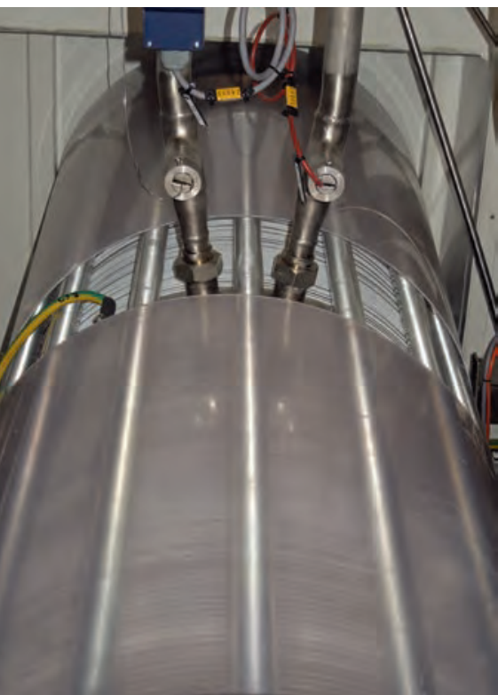
Abb. 3: Elektrolysestack der Firma Hydrogenics zur Wasserstoffherzeugung
