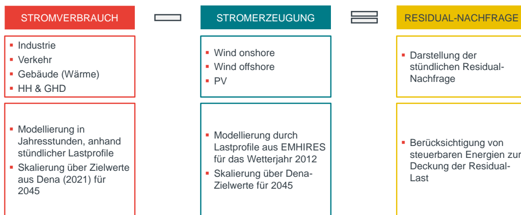
Abbildung 29: Gleichzeitkeitsanalyse EE Erzeugung und Wärmepumpenstromnachfrage
